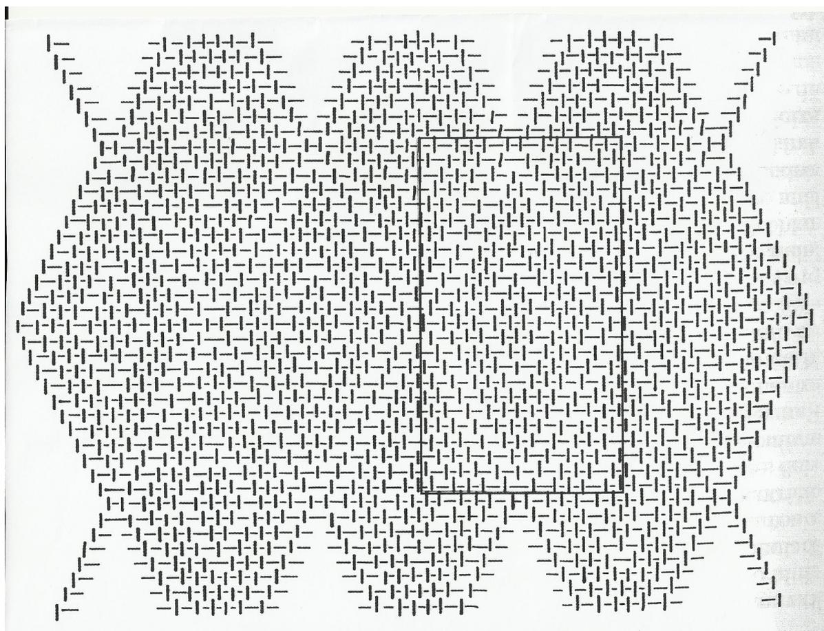
Le trame sono state inserite nel passo di ordito con un ago-navetta e successivamente battute con un pettine.
